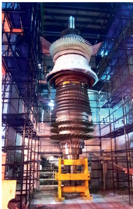
Ротор ГТ в кантователе после сборки
