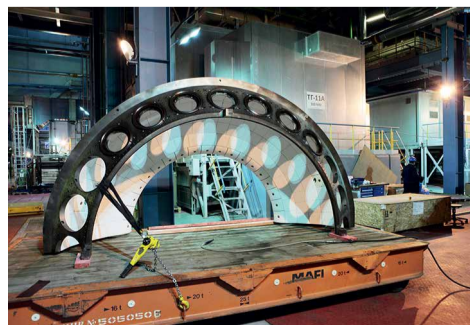
Подготовка к сборке наружного корпуса камеры сгорания ГТ
