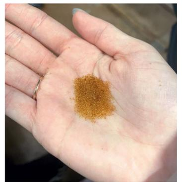
Ионообменная смола, используемая на ТЭЦ для обессоливания воды
