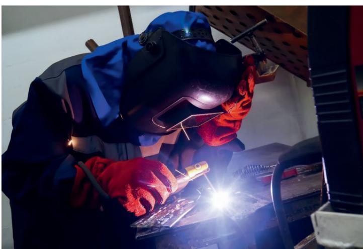
Дуговая сварка плавящимся покрытым электродом
