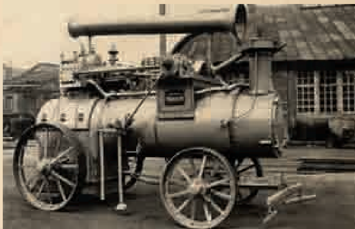
Локомотив – передвижной паровой двигатель для выработки электричества
