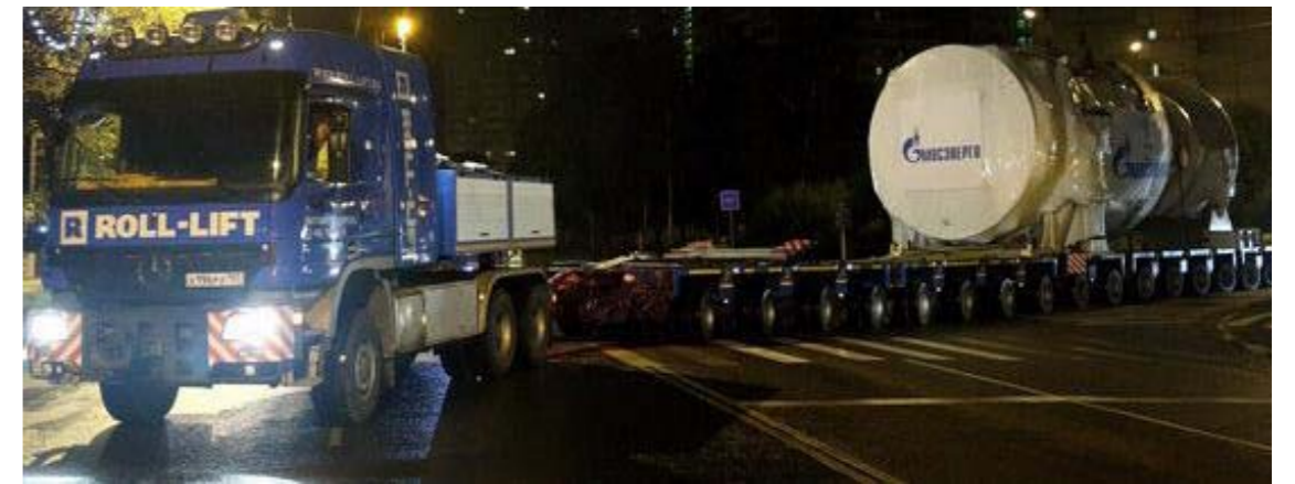
Рис. 12. Доставка новой газовой турбины энергоблока ПГУ-420 на ТЭЦ-20
