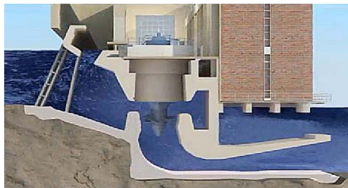
Рис. 40. Схема работы гидротурбины (на примере Лесогорской ГЭС)
