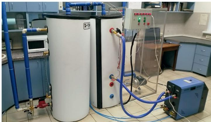
Опытная лабораторная установка термохимического накопления тепловой энергии
