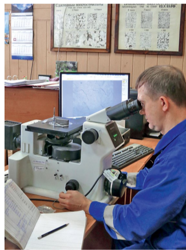
Исследование микроструктуры металла паропровода на репликах
