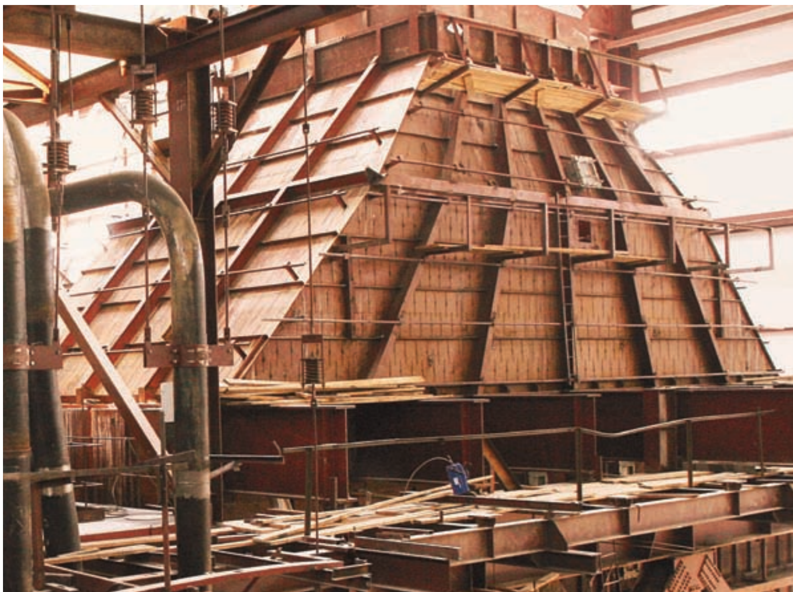
Котел-утилизатор – паровой котел, не имеющий собственной топки и использующий тепло отработанных газов газовой турбины для получения пара высоких параметров, направляемого в паровую турбину
